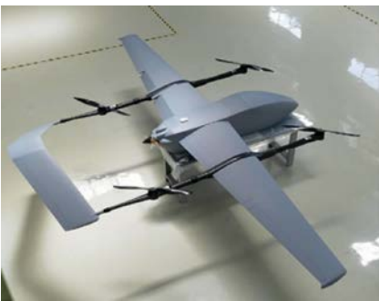
图 8 大型复合翼工程样机 Fig. 8 Largehybrid VTOL UAV
